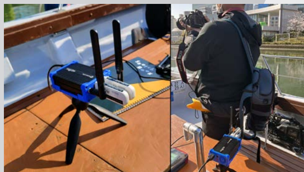
船上ロケでデジタル一眼カメラの HDMI 出力を P2 に接続し、IP 映像伝送
