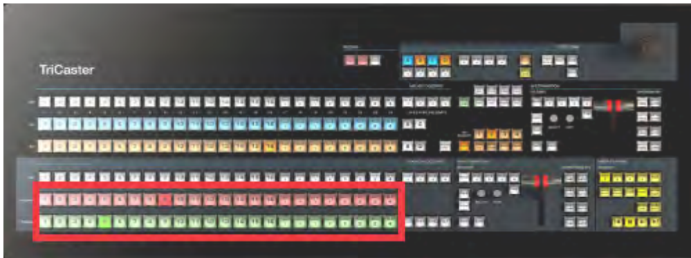
図 488 :TC1LPコントロールサーフェスのMainスイッチャーパネルの入力チャンネルボタン
