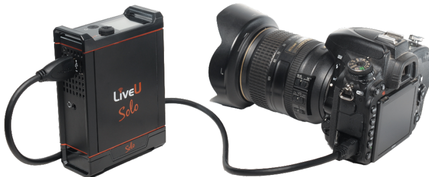
図 25: Solo とデジタル一眼レフカメラを HDMI で接続
