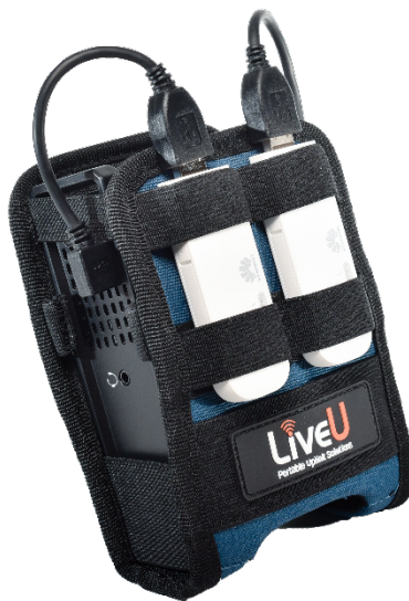
図 26: Solo (SDI/HDMI)とモデムの接続
