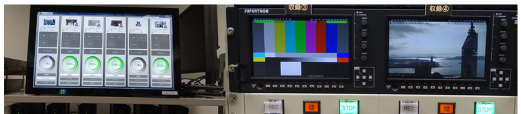
(左から) U2 インジェストと、インジェスターのハードウェアスイッチ (コントロールパネル)
